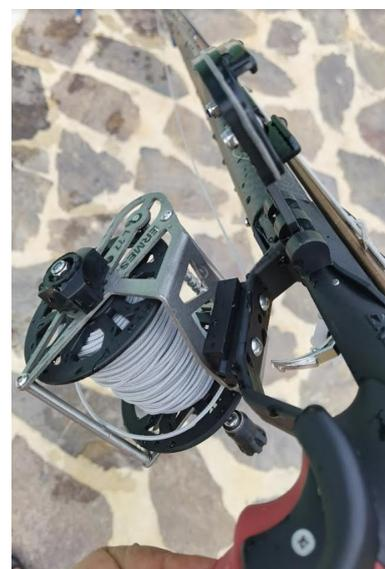
Produciamo due modelli, verticali e orizzontali, Alcuni modelli sono interamente prodotti a CNC ed utilizzando i migliori materiali, Nylon caricato con fibra di vetro, Pom C, acciaio inox aisi 316, e per le parti piane metalliche, acciaio ed a richiesta Titanio. La frizione per tutti i modelli è del tipo a scatti con funzionamento a sfera, il vantaggio è che si può dosare la forza, in modo tale da stancare il pesce.
